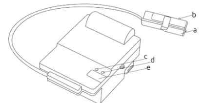
e) Sensor button for sending the current status of the radio module-sensor / Sensortaste zum Senden des aktuellen Status des Funkmodul-Sensors / Сенсорна кнопка для надсилання поточного стану радіомодуля-сенсора
