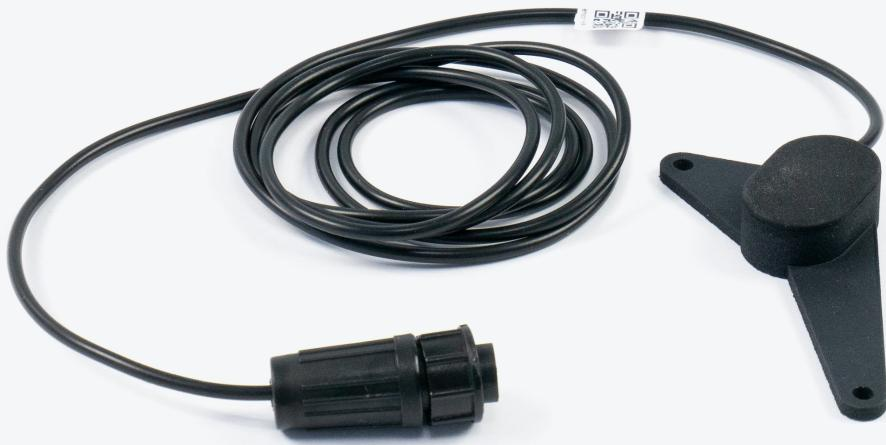
Индуктивный сенсор предназначен для передачи данных с аналоговых водомеров на Импульсный радиомодуль Jooby OMNI RM LoRaWAN 4PU 200 / 204. Устройство устанавливается на корпус прибора учёта и подключается к радиомодулю. После монтажа Сенсор начинает фиксировать число оборотов измерительной стрелки водомера и передавать эти данные Импульсному радиомодулю.
