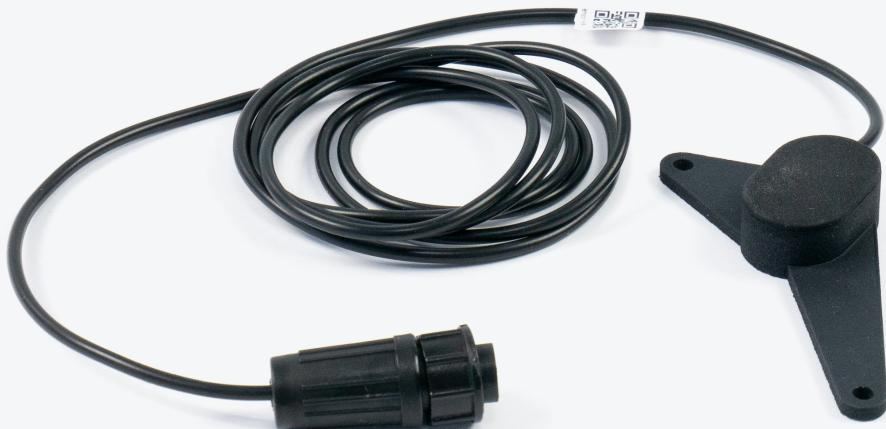
Der induktive Sensor ist zur Übertragung von Daten von analogen Wasserzählern an das Impuls-Funkmodul Jooby OMNI RM LoRaWAN 4PU 200 / 204 bestimmt. Das Gerät wird am Gehäuse des Messgeräts montiert und mit dem Funkmodul verbunden. Nach der Montage beginnt der Sensor, die Anzahl der Umdrehungen des Messzeigers des Wasserzählers zu erfassen und diese Daten an das Impuls-Funkmodul zu übermitteln.
