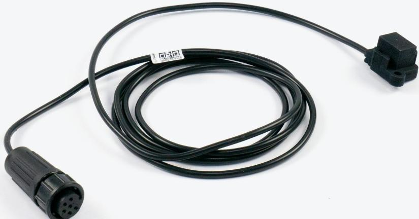
Магнитный сенсор предназначен для передачи показаний водомера на импульсный радиомодуль Jooby OMNI RM LoRaWAN 4PU 204 EU. Сенсор устанавливается на корпус счётчика и подключается к радиомодулю. После монтажа он фиксирует количество оборотов встроенного магнита водомера, формирует импульсы с заданным коэффициентом и передаёт их в импульсный радиомодуль.
