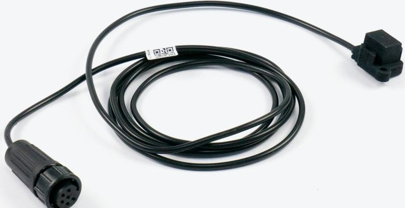
Der magnetische Sensor ist zur Übermittlung der Wasserzählerwerte an das Impuls-Funkmodul Jooby OMNI RM LoRaWAN 4PU 204 EU bestimmt. Der Sensor wird am Gehäuse des Zählers montiert und mit dem Funkmodul verbunden. Nach der Montage erfasst er die Anzahl der Umdrehungen des integrierten Magneten des Wasserzählers, erzeugt Impulse mit einem festgelegten Koeffizienten und überträgt diese an das Impuls-Funkmodul.
