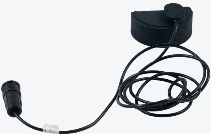
Der optik Sensor erfasst die Umdrehungen des Messzeigers analoger Wasserzähler und überträgt Impulse, deren Anzahl ein Vielfaches der Zeigerumdrehungen ist, an das Funkmodul Jooby OMNI RM LoRaWAN 4PU 204EU.
