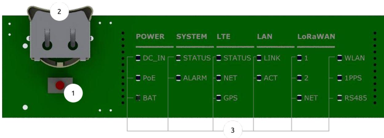
Abbildung 6: Anzeigeplatine
