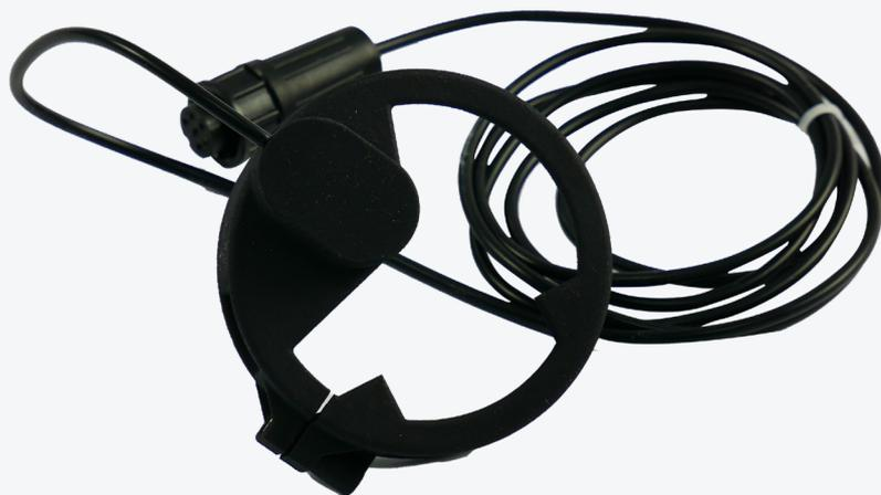
Optischer Sensor zur Übertragung der Zählerstände von analogen Wasserzählern an das Impuls-Funkmodul **Jooby OMNI RM LoRaWAN 4PU 200 / 204 / 205 EU**. Der Sensor wird am Zählergehäuse angebracht und mit dem Funkmodul verbunden. Danach wird mit dem Sensor die Zahl der Umdrehungen der Zähleranzeige optisch erfasst und an das Funkmodul übertragen.
