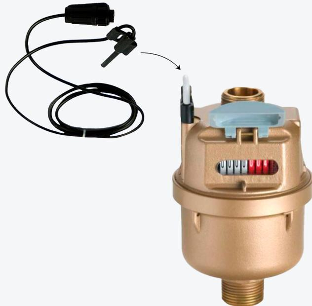
Magnetischer Sensor zur Übertragung der Zählerstände von Wasserzählern an ein am Zählergehäuse montiertes, kompatibles Impuls-Funkmodul. Der Sensor mit dem Anschlusstyp "Open Contact" erfasst die Anzahl der Umdrehungen des Magneten im Wasserzähler. Diese Daten werden in Form von Impulsen mit einem eingestellten Impulsverhältnis an das Funkmodul übertragen.
