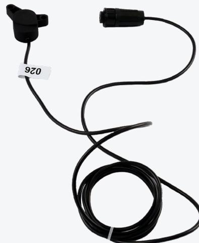
Индуктивный сенсор предназначен для передачи данных с аналоговых водомеров на Импульсный радиомодуль Jooby OMNI RM LoRaWAN 4PU 200 / 204 / 205 EU. Устройство монтируется на корпус прибора учета и подключается к радиомодулю. После этого Сенсор начинает фиксировать количество оборотов измерительной стрелки счетчика воды и передавать данные Импульсному радиомодулю.
