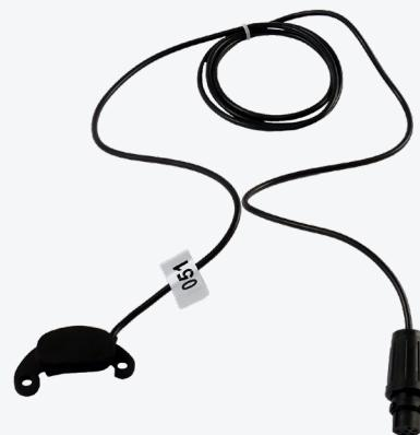
Индуктивный сенсор предназначен для передачи данных с аналоговых водомеров на Импульсный радиомодуль Jooby OMNI RM LoRaWAN 4PU 200 / 204 / 205 EU. Устройство монтируется на корпус прибора учета и подключается к радиомодулю. После этого Сенсор начинает фиксировать количество оборотов измерительной стрелки счетчика воды и передавать данные Импульсному радиомодулю.
