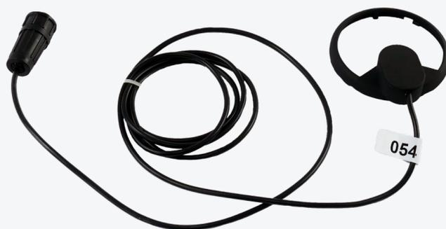
Индуктивный сенсор предназначен для передачи данных с аналоговых водомеров на Импульсный радиомодуль Jooby OMNI RM LoRaWAN 4PU 200 / 204 / 205 EU. Устройство монтируется на корпус прибора учета и подключается к радиомодулю. После этого Сенсор начинает фиксировать количество оборотов измерительной стрелки счетчика воды и передавать данные Импульсному радиомодулю.
