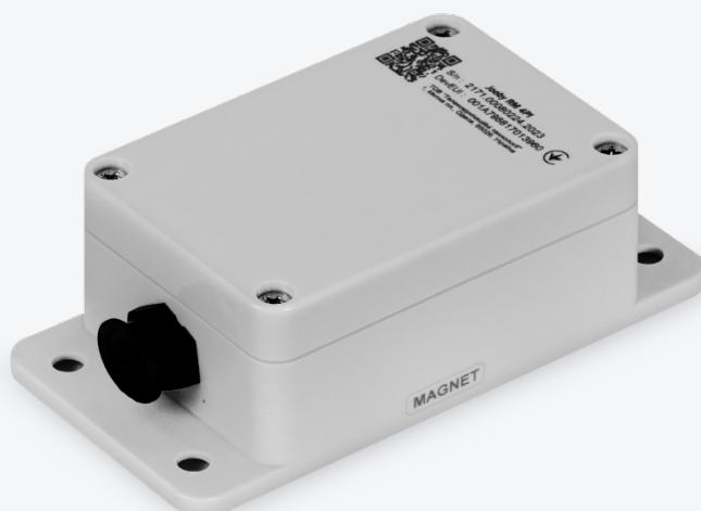
Радиомодуль для нескольких типов счетчиков позволяет поставщикам и управляющим компаниям своевременно получать актуальные данные о потребленных ресурсах. Устройство подключается к приборам учета с помощью интеллектуальных сенсоров и фиксирует счетные импульсы. Затем система передает полученные данные на сервер по беспроводной сети LoRaWAN, где они преобразуются в показания и становятся доступны поставщику в админпанели.
