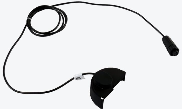
Dieser optische Sensor hat die Aufgabe, Messdaten von analogen Wasserzählern an das Impuls-Funkmodul Jooby OMNI RM LoRaWAN 4PU 200 / 204 / 205 EU zu übertragen. Der Sensor wird am Zählergehäuse montiert und mit dem Funkmodul verknüpft. Danach nimmt er die Umdrehungen des Wasserzählers auf und leitet diese Informationen an das Impuls-Funkmodul weiter. Die Impulszahl, die übermittelt wird, ist entweder identisch mit der Anzahl der Umdrehungen
