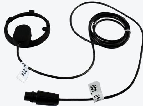
Der optische Sensor dient zur Übertragung von Messwerten analoger Wasserzähler an das Impuls-Funkmodul Jooby OMNI RM LoRaWAN 4PU 200 / 204 / 205 EU. Der Sensor wird auf dem Zählergehäuse montiert und an das Funkmodul angeschlossen. Danach beginnt der Sensor damit, die Anzahl der Umdrehungen des Wasserzählers aufzuzeichnen und diese Daten an das Impuls-Funkmodul zu übertragen.
