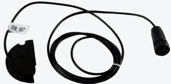
Dieser induktive Sensor ist dazu bestimmt, die Zählerstände analoger Wasserzähler an das Funkmodul Jooby OMNI RM LoRaWAN 4PU 200 / 204 / 205 EU zu übermitteln. Nach der Befestigung am Zählergehäuse wird der Sensor mit dem Funkmodul verbunden. Anschließend erfasst er die Anzahl der Umdrehungen des Wasserzählers und überträgt diese Daten an das Impuls-Funkmodul.
