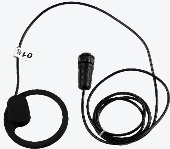
Der Zweck dieses induktiven Sensors besteht darin, Daten von analogen Wasserzählern an das Impuls-Funkmodul Jooby OMNI RM LoRaWAN 4PU 200 / 204 / 205 EU zu senden. Der Sensor wird am Gehäuse eines Wasserzählers montiert und anschließend mit dem Funkmodul verknüpft. Er nimmt die Zählerumdrehungen auf und leitet diese Informationen an das Impuls-Funkmodul weiter.
