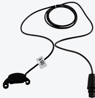
Dieser induktive Sensor dient dem Zweck, Zählerstände analoger Wasserzähler an das Funkmodul Jooby OMNI RM LoRaWAN 4PU 200 / 204 / 205 EU zu übertragen. Nach der Installation am Zählergehäuse wird der Sensor an das Funkmodul angeschlossen. Von da an erfasst der Sensor kontinuierlich die Umdrehungen des Wasserzählers und überträgt diese Daten an das Impuls-Funkmodul.
