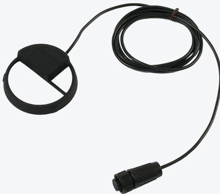
Оптический сенсор предназначен для передачи данных с аналоговых водомеров на Импульсный радиомодуль **Jooby OMNI RM LoRaWAN 4PU 201 EU**. Устройство монтируется на корпус прибора учета и подключается к радиомодулю. После этого Сенсор начинает фиксировать количество оборотов измерительной стрелки счетчика воды и передавать данные Импульсному радиомодулю.
