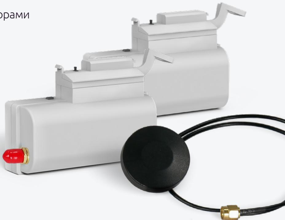
Радиомодуль для счетчика газа Metrix позволяет поставщикам и управляющим компаниям получать точные и актуальные данные о потребленном газе. Устройство автоматически считывает показания прибора учета и с заданной частотой отправляет данные на сервер по беспроводной сети LoRaWAN. После обработки они преобразуются в показания и становятся доступны поставщику в системе учета. Для инсталляции Jooby Epir RMS не требуется снимать счетчик. Радиомодуль активируется через мобильное
