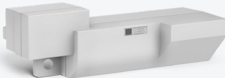
Dieses Funkmodul für Samgas-Gaszähler ermöglicht es Versorgern und Verwaltungsgesellschaften, schnell genaue Daten über den Gasverbrauch zu erhalten. Das Gerät erfasst automatisch die Zählerstände und sendet die Daten über ein drahtloses LoRaWAN-Netz in bestimmten Zeitabständen an den Server. Die Software wandelt die Daten dann in Zählerstände um und die Informationen stehen dem Versorger im
